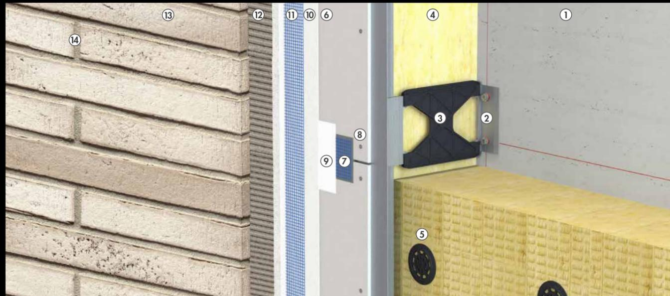
**Systemaufbau:** 1 Untergrund 2 Hilti Verankerungselement 3 Hilti Unterkonstruktion 4 Knauf Insulation Fassaden-Dämmplatte 5 Hilti Dämmstoffbefestiger 6 AQUAPANEL® Cement Board Outdoor 7 AQUAPANEL® Fugenband 8 AQUAPANEL® Fassadenschraube 9 AQUAPANEL® Fugenspachtel grau 10 AQUAPANEL® Klebe- und Armiermörtel weiß 11 AQUAPANEL® Gewebe 12 Knauf Flex-Fliesenkleber 13 Feldhaus Klinkerriemchen 14 Knauf Flex-Fugenmörtel
