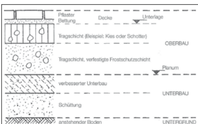
Abb. Aufbau einer Verkehrsflächenbefestigung mit Klinkerpflaster.
